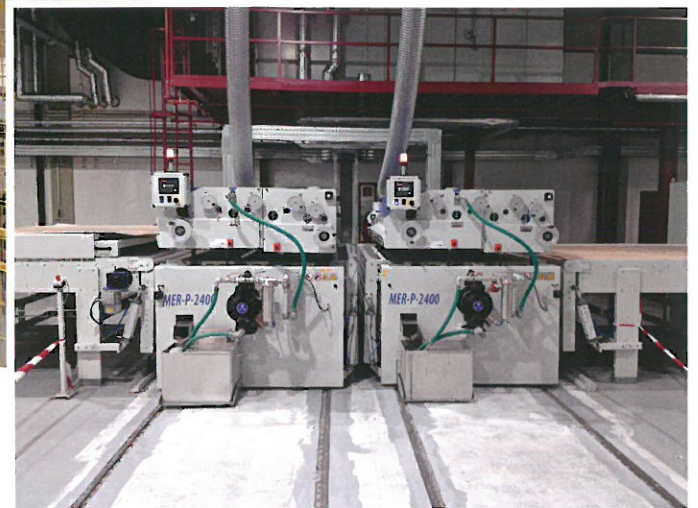
Montagephase der „Hot Coating“-Anlage im November 2017, der Produktionsstrang ist installiert, der Auslauf aus dem Reinraumbereich ist sichtbar, ebenso UV-Härteinheiten und verfahrbare Walzenauftragmaschinen
