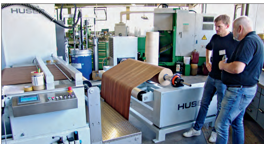
Startpunkt der Anlage mit Abwickler rechts und Spleißtisch links.
