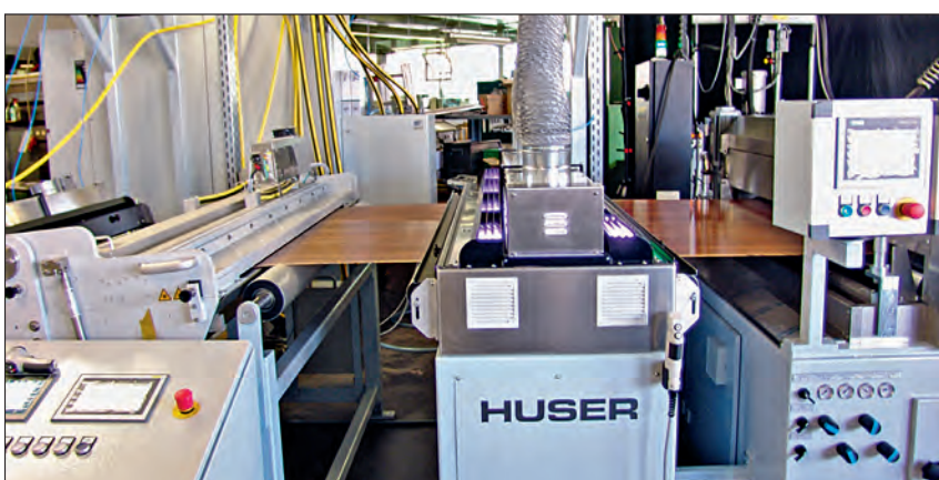
Auftrag des zweiten Topcoat rechts, Gelierung (Mitte) und links nach Bedarf Aufbau einer Mattoberfläche mittels Excimer-Technologie.
