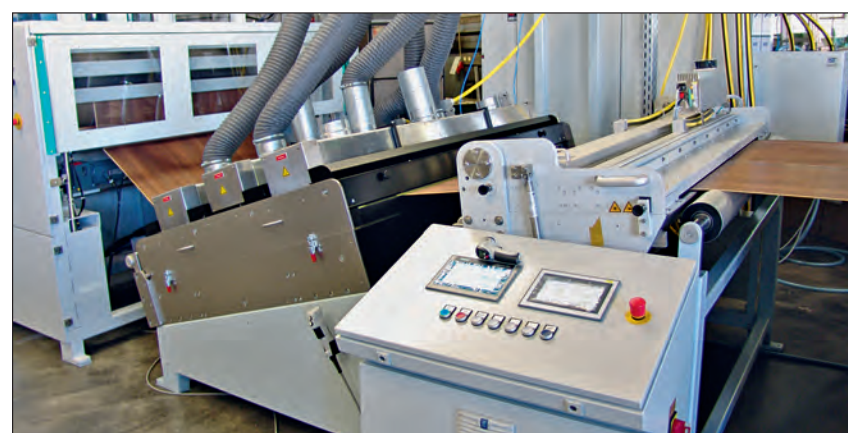
Nach dem Excimer (rechts) werden die Oberflächen UV-gehärtet (Mitte) und bei Bedarf noch geprägt (links). Fotos: Fischer
