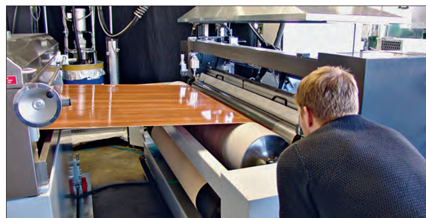
Im rechten Maschinenteil wurde gerade das „Hot Coating“ aufgebracht, anschließend folgt die Aufgabe des ersten Topcoat (links).
